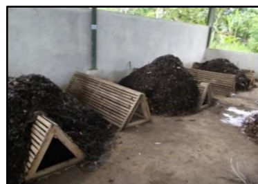
b. Terowongan bambu ( open windrow )
